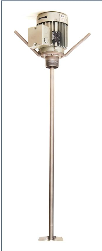
Die Welle wird durch die 2“ Spundlochöffnung des Standard-200-l-Fasses eingeführt, und mittels des Gewindes auf die Öffnung aufgeschraubt. Durch die Fliehkräfte und den dynamischen Auftrieb im Medium klappt das Rührorgan (bzw. die Rührorgane) nach Einschalten des Antriebes auf, das Medium wird gemischt.
